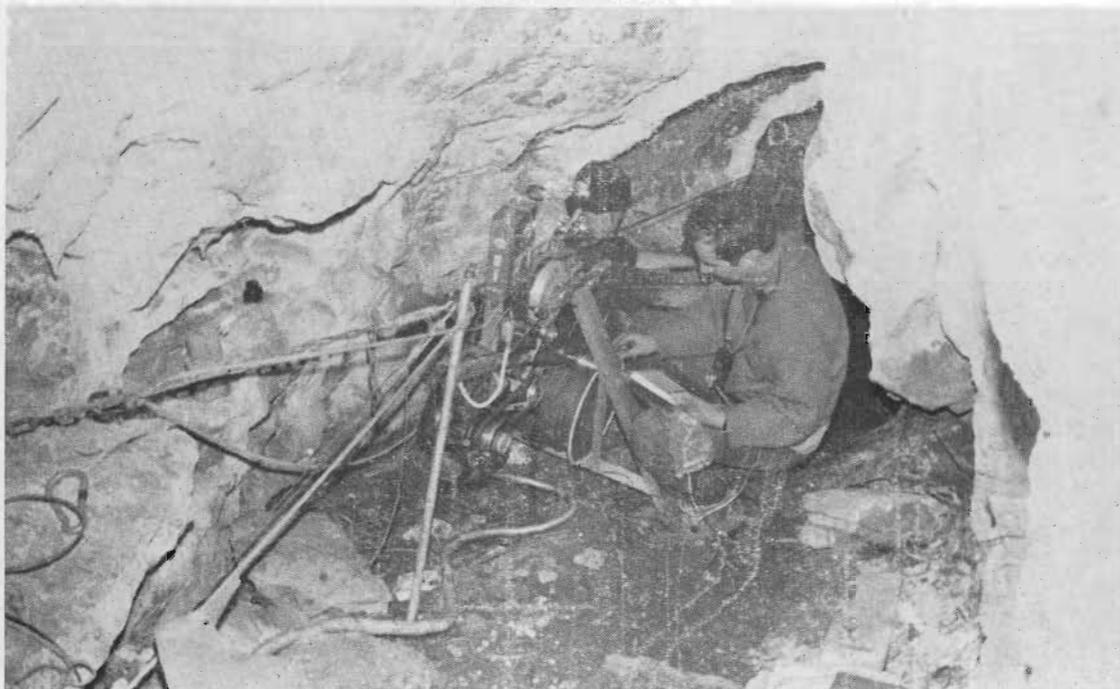
Foto n.º 8.—Torno a motor que sustituye al torno a pedales de la foto n.º 7, instalado a la boca del Gran Pozo de -314 m. en la galería de entrada, galería del Torno, de la sima del Cueto. Foto cortesía del Dr. CASTIN.
