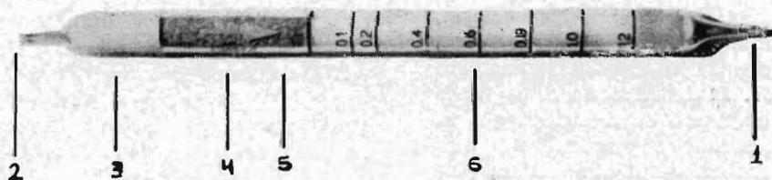
MODELO DE TUBO REACTIVO PARA MEDIR EL CO<sub>2</sub>.—1 y 2, Extremos para romper; 3, Zona indicadora; 4, Flecha indicadora para la dirección del tubo; 5, Cartucho pre-purificador; 6, Escala de medidas.
