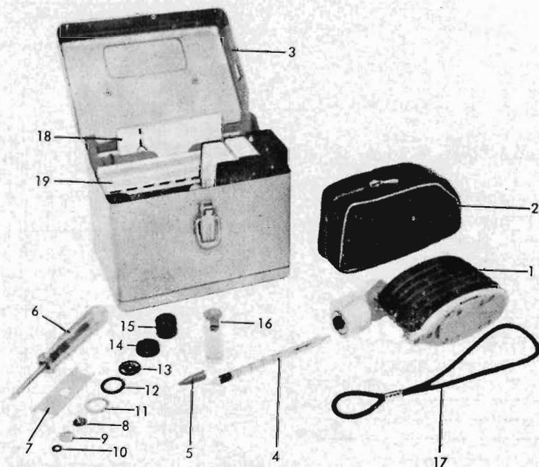
APARATO DRAEGER.—1, Bomba del detector de gases Dräger, mod. 31; 2, Bolsa protectora; 3, Caja portadora; 4, Tubo Dräger; 5, Protector de goma; 6, Destornillador especial; 7, Llave especial; 8, Cuerpo de válvula; 9, Disco perforado; 10, Arandela; 11, Arandela; 12, Arandela de goma; 13, Arandela tapa; 14, Válvula de asiento; 15, Goma de taponamiento; 16, Para rotura de protección; 17, Sujetador de la bomba; 18, Instrucciones; 19, Tabla.
